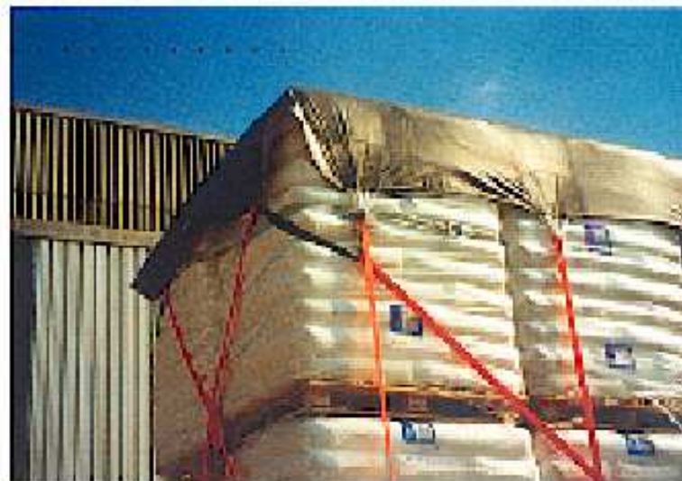
Joonis 42: Sidemetega kinnitatud kate
