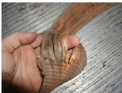
Joonis 36: Tugevasti kahjustatud koormarihm? Visake see prügikorvi!
